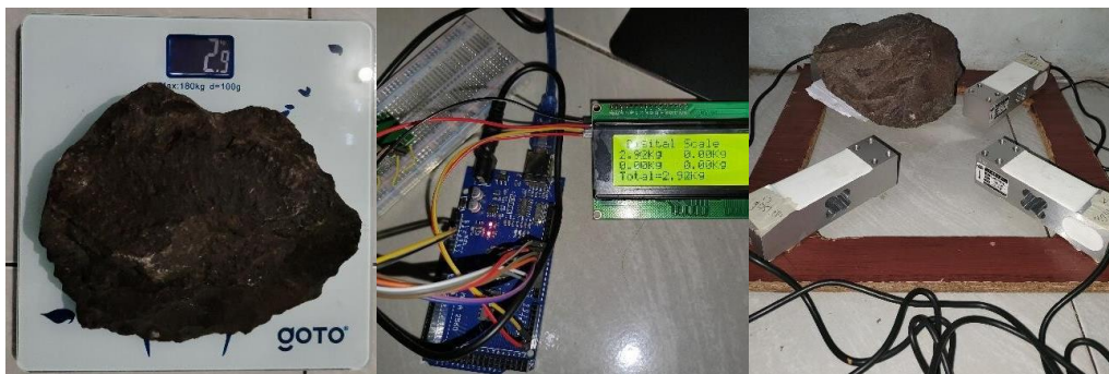
Gambar 4 Sistematis Proses Kalibrasi Load Cell
