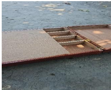
Gambar 2 Pemasangan Engsel di Bagian Bawah
