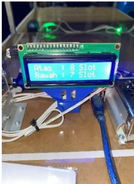
Gambar. 10 Ketika kendaraan melewati sensor Infrared pada lantai 1
