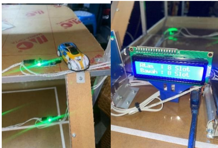
Gambar. 12 Ketika kendaraan melewati sensor Infrared untuk keluar
