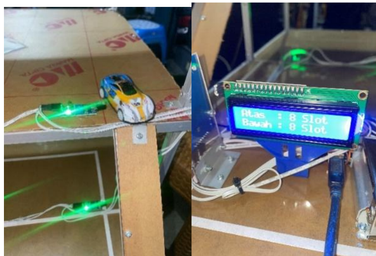
Gambar. 12 Ketika kendaraan melewati sensor Infrared untuk keluar
