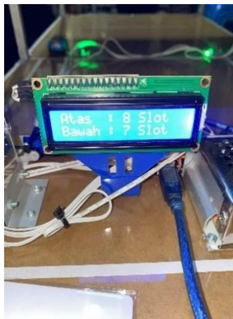
Gambar. 10 Ketika kendaraan melewati sensor Infrared pada lantai 1
