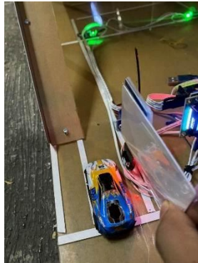
Gambar 9. Ketika Kendaraan melewati Sensir Infrared pada Lantai 1
