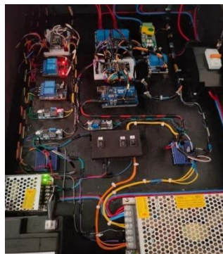
Gambar 12. Rangkaian disupply oleh sumber cadangan
