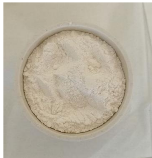
Gambar 1. Serbuk Cangkang Kerang Darah Setelah Kalsinasi
