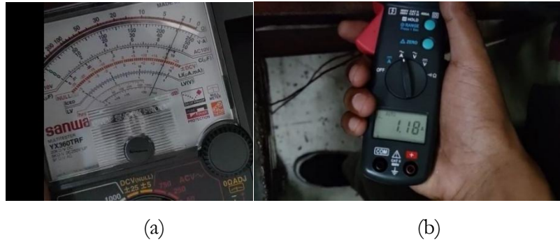
Gambar 8. (a) Pengukuran tegangan terukur dengan beban, (b) Pengukuran arus terukur dengan beban
