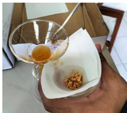
Gambar 7.(a) Penyaringan mikroplastik dan (b) Penimbangan massa mikroplastik
