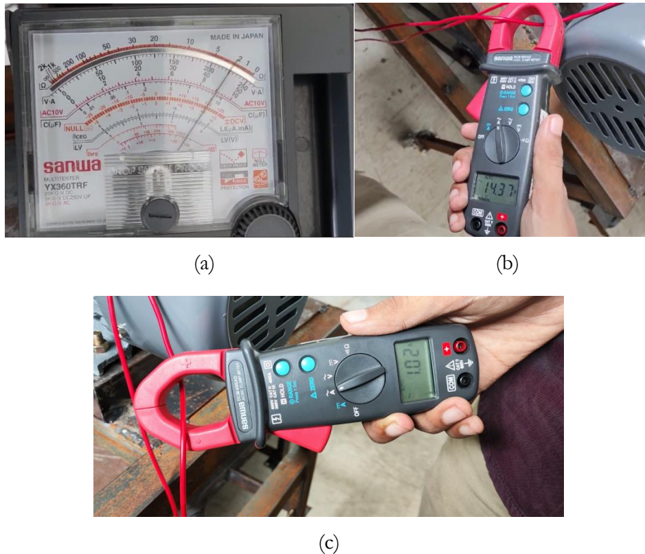
Gambar 7. (a) Pengukuran tegangan terukur tanpa beban, (b) Pengukuran arus starting , (c) Pengukuran arus terukur tanpa beban
