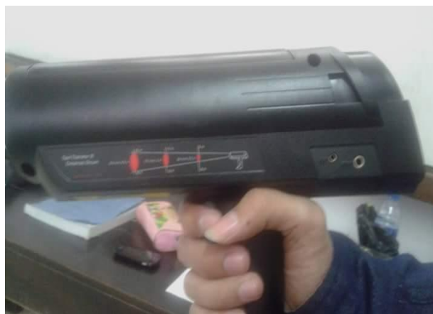
Gambar 3. Pirometer untuk mengukur suhu material
