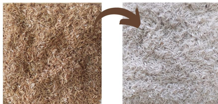
Gambar 1. Hasil Furnace sekam padi
