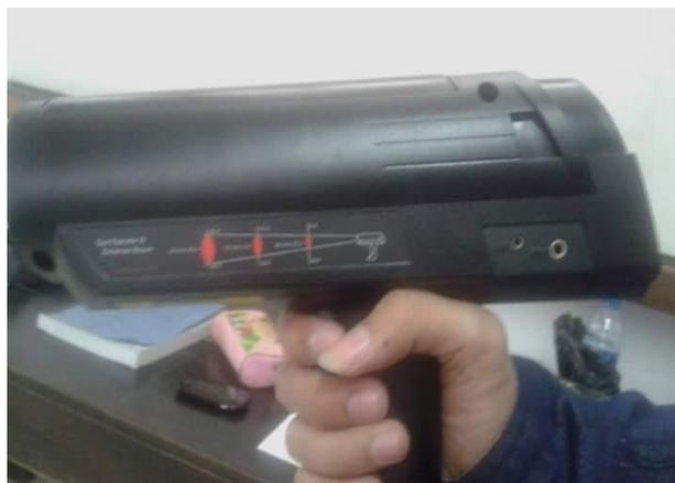
**Gambar 3.** Pirometer untuk mengukur suhu material
