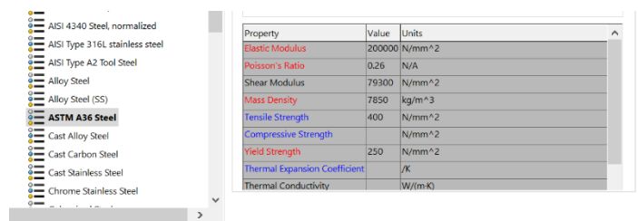
Gambar 3 Melakukan input jenis material ASTM A36 Steel
