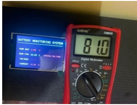
Gambar 2 Perbandingan Datalogger dengan Multimeter
