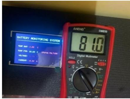
**Gambar 2** Perbandingan Datalogger dengan Multimeter
